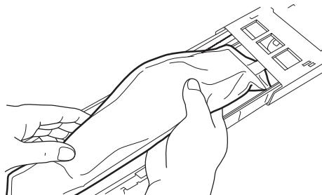
(4) パウチトレイのローラーの下にインクパウチの後端を差し込み、まっすぐになるよう配置する。
