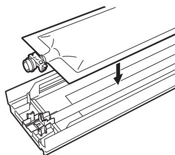
(2) 以下の手順でインクパウチの先端をパウチトレイに取り付ける。
