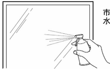
市販の霧吹きで、中性洗剤を2～3滴含んだ水を貼り付け面に十分吹き付けます。
